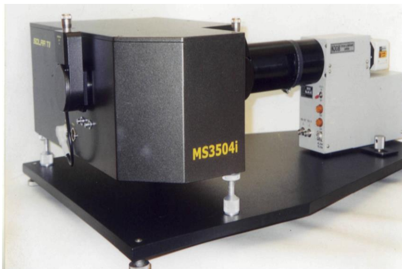
Рис.1. Внешний вид изображающего времяанализирующего монохроматора/спектрографа SVA-01.
