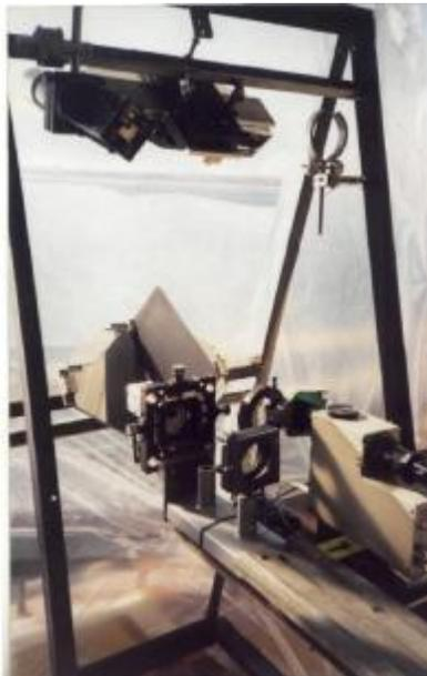
Рис.1. Выходная часть макета ЛИДАРа
