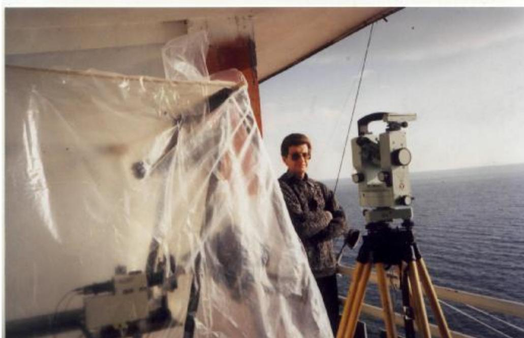
Рис.2. Выходная часть макета ЛИДАРа на фоне балкона и озера (слева видна камера, в центре теодолит на треноге, а справа внизу трос)
