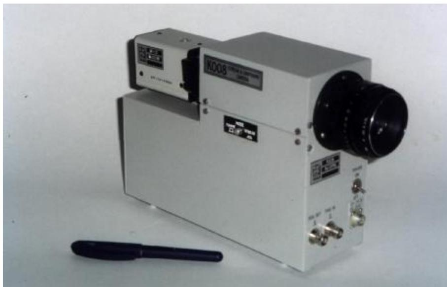
Рис.4. Электронно-оптическая камера K008.
