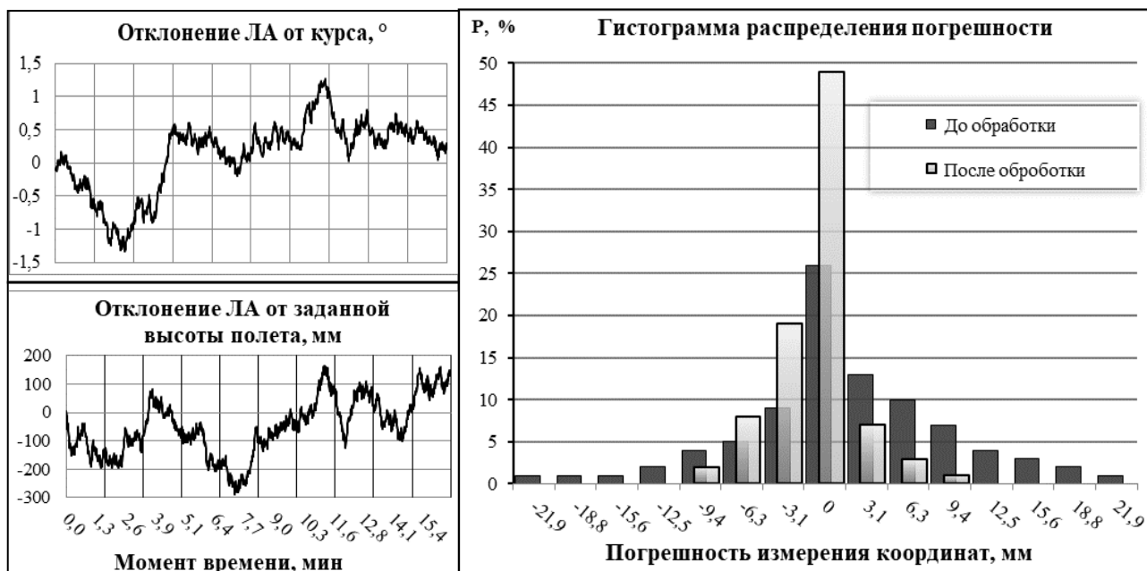
Рисунок 25 – Результаты имитационного моделирования аэрофотосъемки
