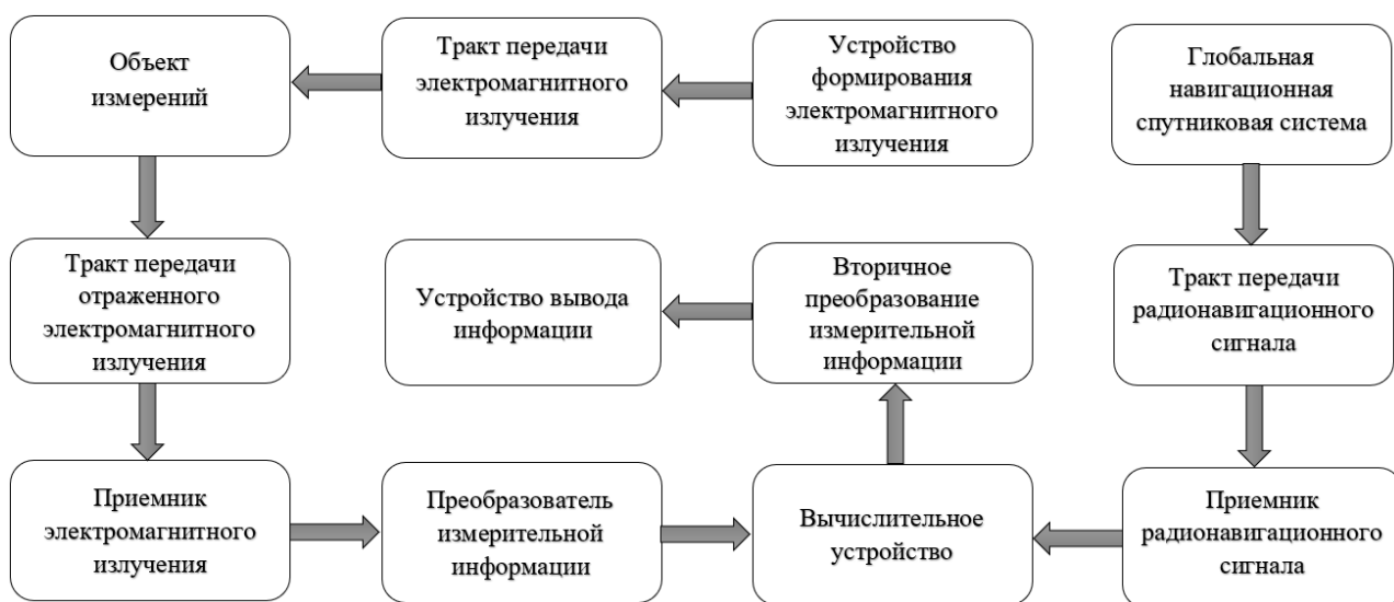
Рисунок 6 – Блок-схема преобразования измерительной информации в ВСКЗ
