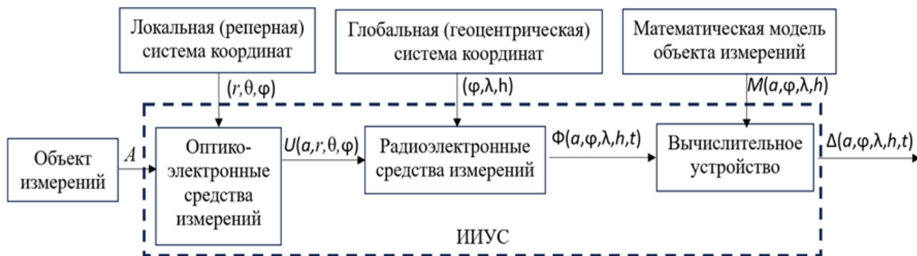
Рисунок 4. – Схема преобразований измерительной информации в ВСКЗ для контроля геометрических параметров железнодорожного пути
