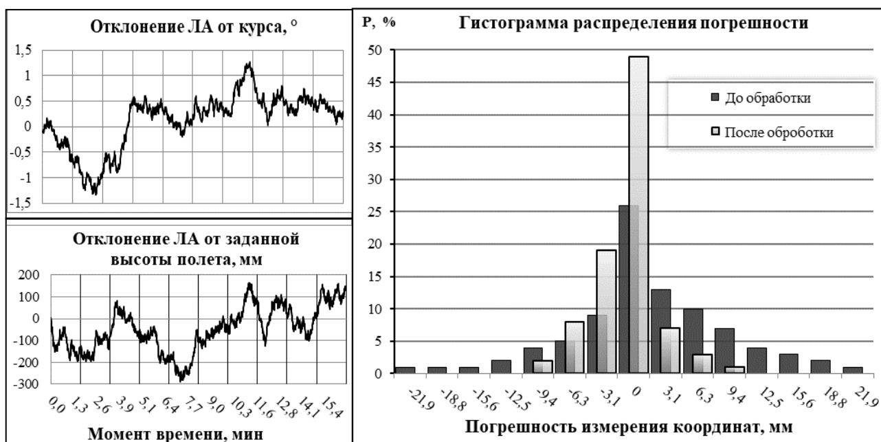
Рисунок 25 – Результаты имитационного моделирования аэрофотосъемки
